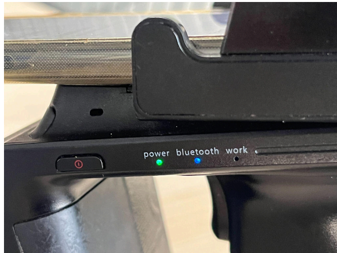
Gambar 1. 6 Contoh Mobile Reader Chainway yang telah terkoneksi dengan Android
